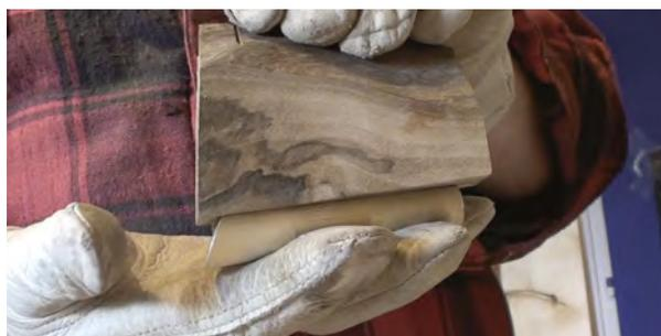
Das Nussholz-Stück wird mit zwei Dübeln auf den abgeflachten Messing-Bolzen geleimt.
