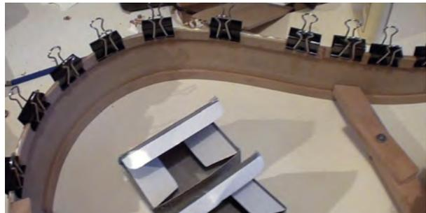
Der Kopf wird mit der Decke und den Zargen verleimt.
