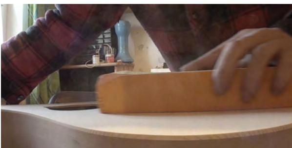
Das **Griffbrett** aus Nussholz wird gehobelt, gekürzt und an die Form des Schallloches angepasst.
